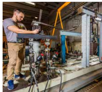
Banco prova per test (distruttivi o non distruttivi) di affidabilità strutturale su componenti anche di grosse dimensioni fino a 100 kN di carico.
