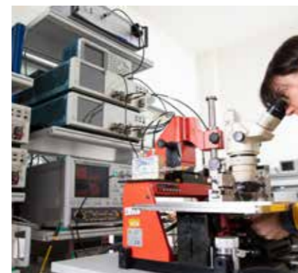
Misure on-wafer di componenti elettronici per microonde e onde millimetriche. Il setup consente misure fino alla frequenza di 65 GHz.
