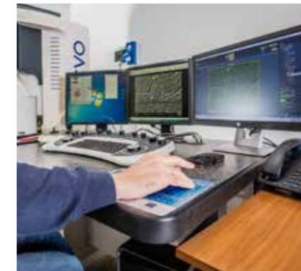
Microscopio elettronico a scansione (SEM) per osservazioni microstrutturali e frattografiche di campioni metallurgici e non, controllo qualità, failure analysis.
