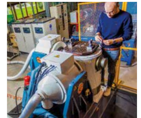
Tavola vibrante elettrodinamica (500x500 mm) per eccitazioni triassiali simultanee con forze fino a 10 kN e frequenza fino 2 kHz; massimo payload 100 kg. Permette la replica delle eccitazioni triassiali in esercizio e prove di durata accelerate.
