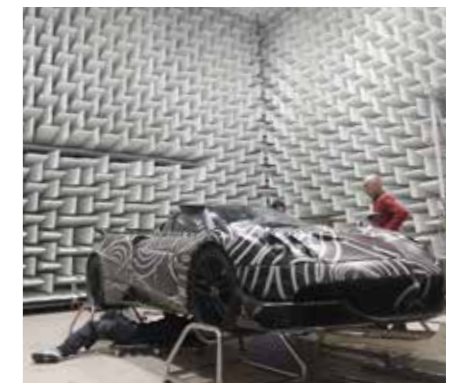
Camera Anecoica Acustica per misure e certificazioni di rumorosità di macchine e apparecchiature: è un ambiente con elevate proprietà di assorbimento acustico, in cui è possibile eliminare la quasi totalità delle riflessioni sonore. Con dimensioni 10.5 x 9.5 x 8.3 m, è una delle più grandi camere pubbliche in Europa. Ha una frequenza di taglio inferiore di 50 Hz e può essere allestita come completamente anecoica o semianecoica.
