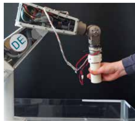
Interazione fisica sicura tra umano e robot: hand guidance di un manipolatore industriale (Puma 260 con elettronica custom)
